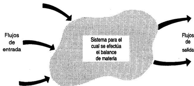
**Figura 3.2** La figura ilustra un sistema de volumen especificado en el cual se efectuarán balances de materia. No nos interesan los detalles internos, sino sólo el paso de materiales a través de las fronteras del volumen y el cambio global de materiales dentro del sistema.
