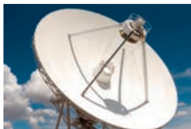
Las antenas de disco son paraboloides de revolución
